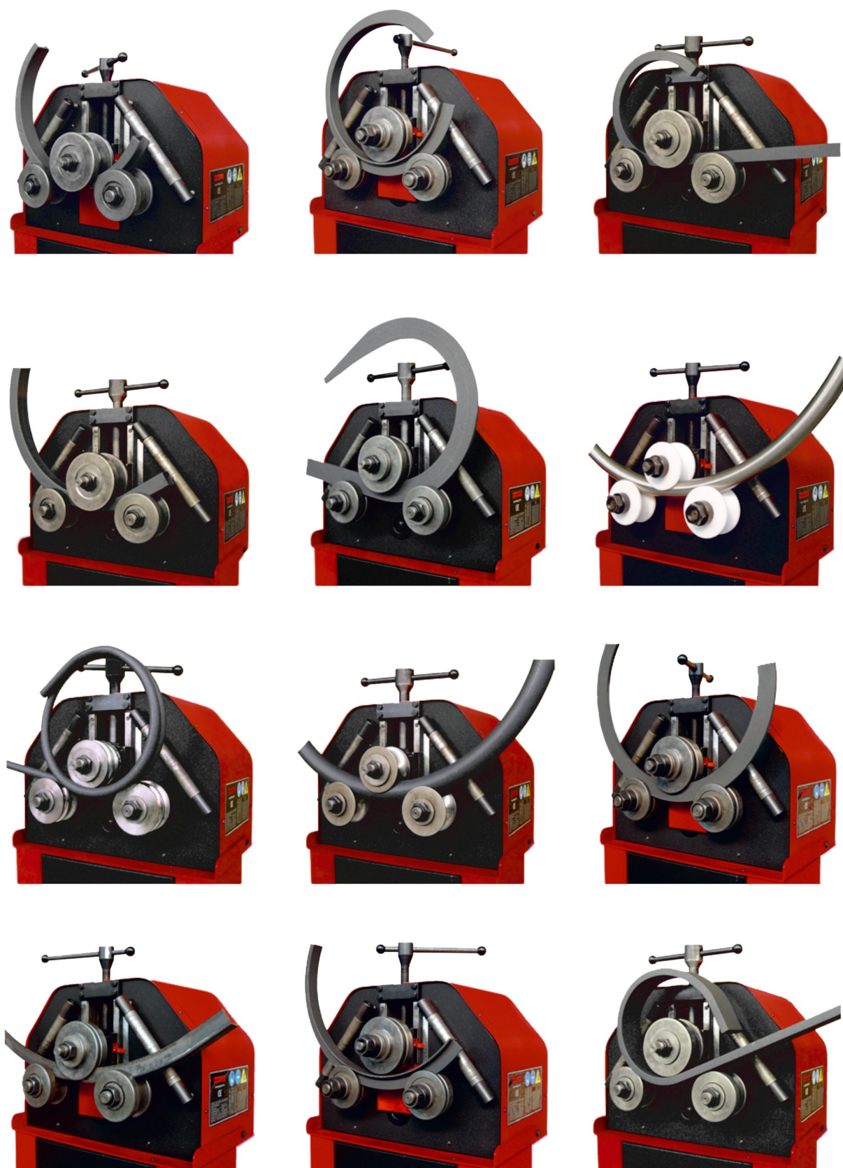
Figura 13. Ejemplos de curvado en diferentes tubos y perfiles
